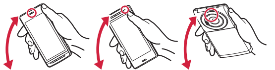
＜受話口の水抜き＞ ＜送話口の水抜き＞ ＜スピーカーの水抜き＞
