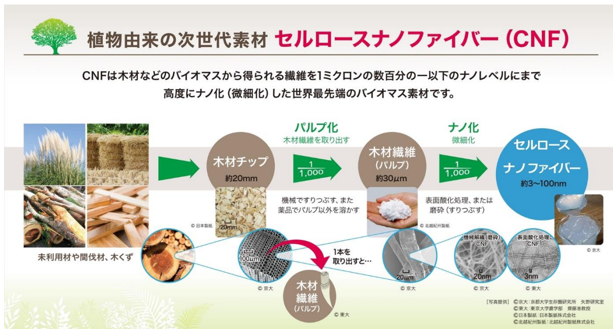
図 P-1 セルロースナノファイバー製造の概要図
