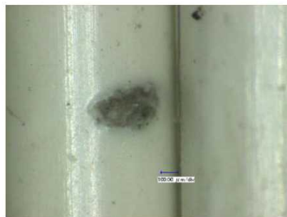
超高速衝突試験後の電力ハーネス表面
