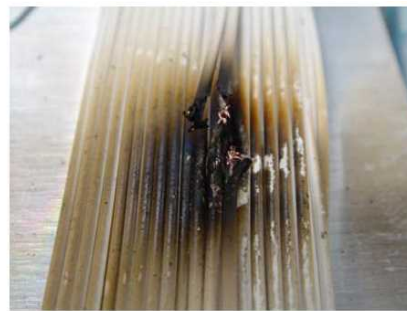
超高速衝突試験後の電力ハーネス表面
