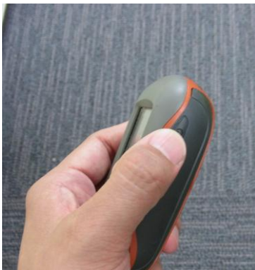
GPS の起動（電源長押し）
