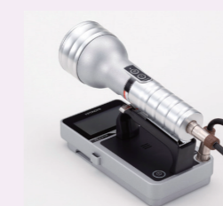
①放射性物質の有無を調べるGM計数管(ガイガー・ミュラー・カウンタ)
