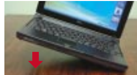
パソコン動作時の片持落下試験
