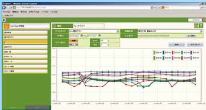
蓄電池電圧のトレンドグラフ画面 (複数セルの監視)
