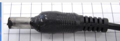
発熱して変形したDCプラグ
