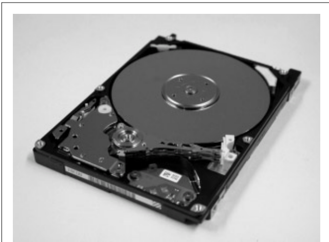
図1 . MK6021GAS の内部構造 - COCや新型サスペンションを採用し、大容量化、高性能化を図っている。 Mechanism of MK6021GAS HDD
