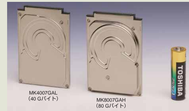
図2. 垂直磁気記録方式を採用した 1.8 型 HDD — 世界で初めて垂直磁気記録方式を採用し、133 G ビット/in 2 という世界最高記録密度の 1.8 型 HDD の製品化に成功しました。
