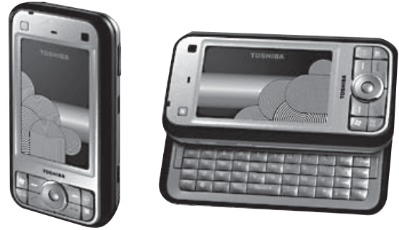
図2. PORTÉGÉ G900 — 横スライダを装備し、3.0型のLCD及びQWERTYキーボードを搭載している。
