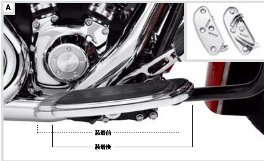
A エクステンデッドリーチ・ライダーフットボードパン／スウィプトウイングシェイプ
