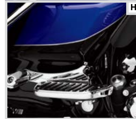
H アジャスタブル・補助パッセンジャーフットペグマウント／リア位置
