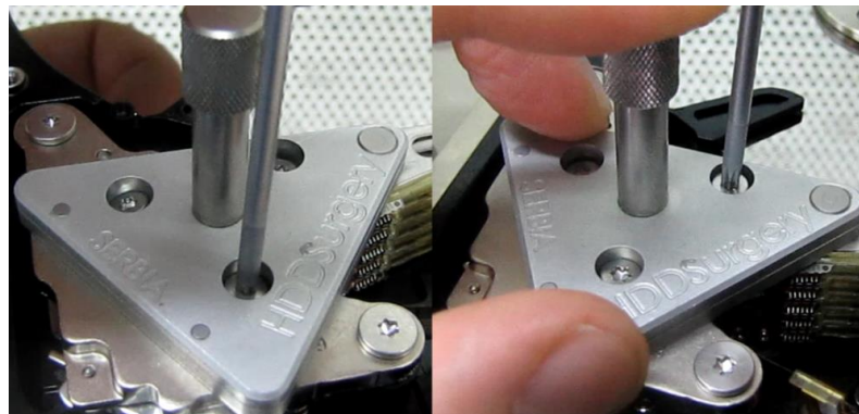
図 8.12 (ヘッドと上部マグネットからサポートツールのネジを取り外す)
