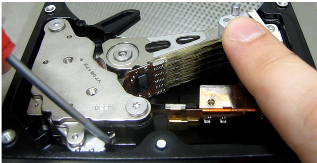
図 8.14 (ランプの左にヘッドを移動させる)
