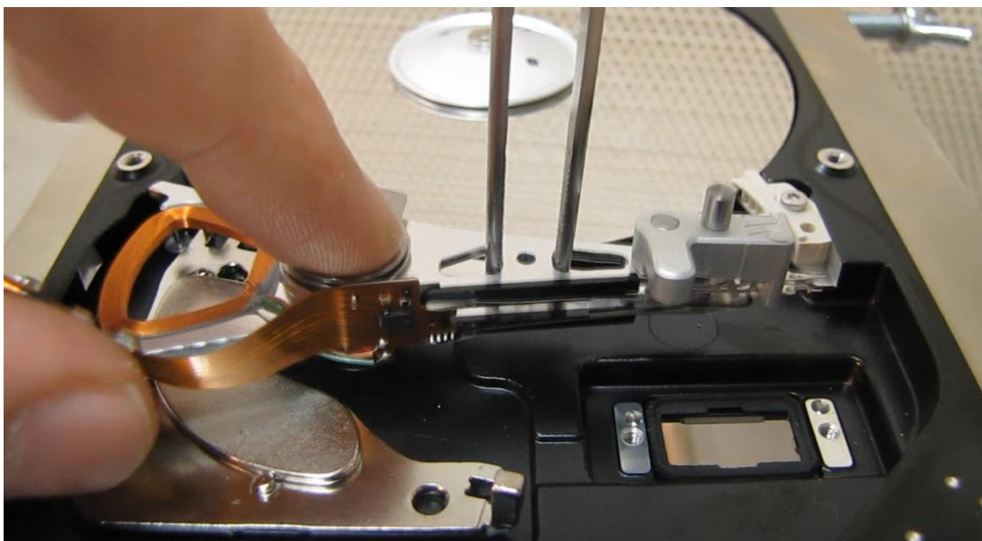
図 6.9 (ドナードライブからヘッドを分離する)
