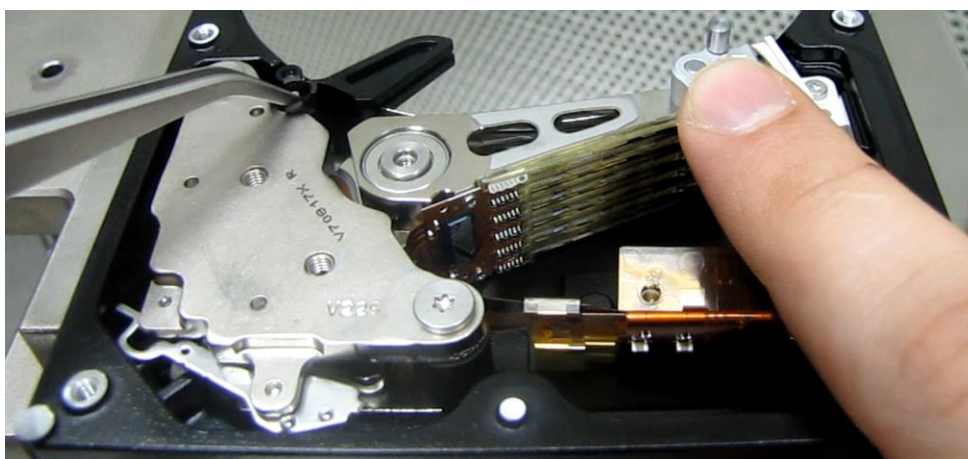
図 8.15 (安全装置を障害ドライブの元の位置に戻す)
