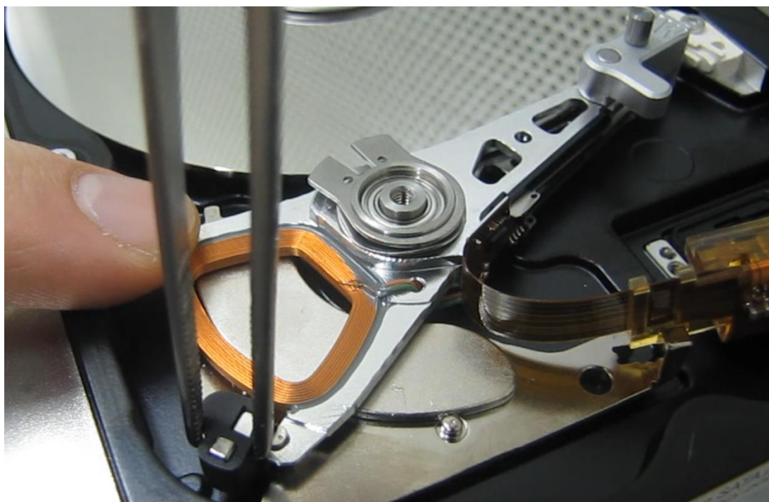
図 6.6 (ピンセットでゴム製装置を取り外す)
