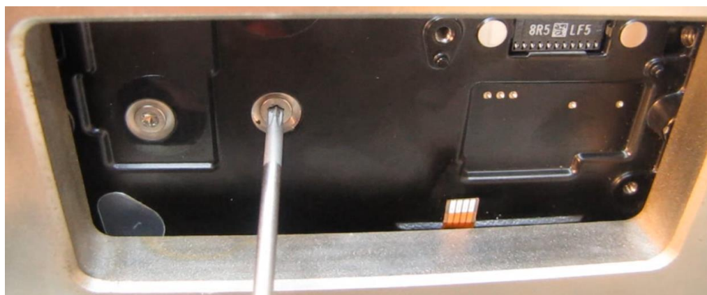
図 6.11 (障害ドライブにヘッドが正しく固定されるようにネジをしっかりと締める)
