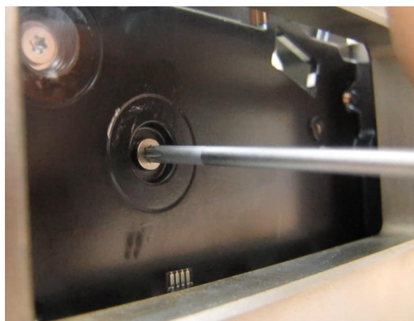
図 7.8 (下からネジを締めてヘッドを固定する)
