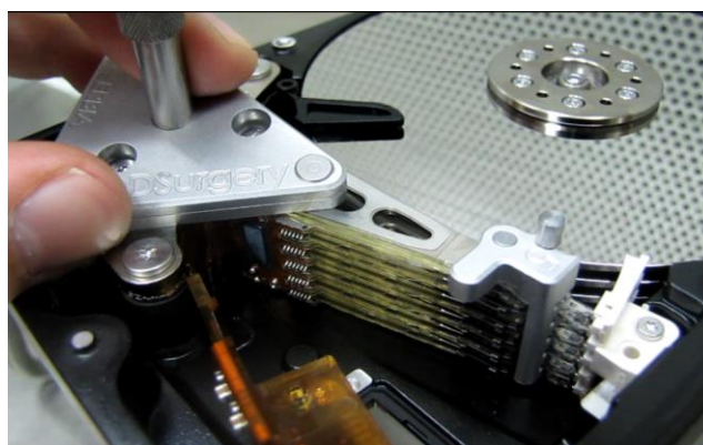
図 8.13 (ランプにヘッドを移動)
