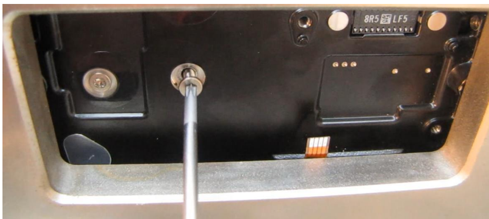
図 6.8 (ドナードライブにヘッドアームを固定しているネジを取り外す)
