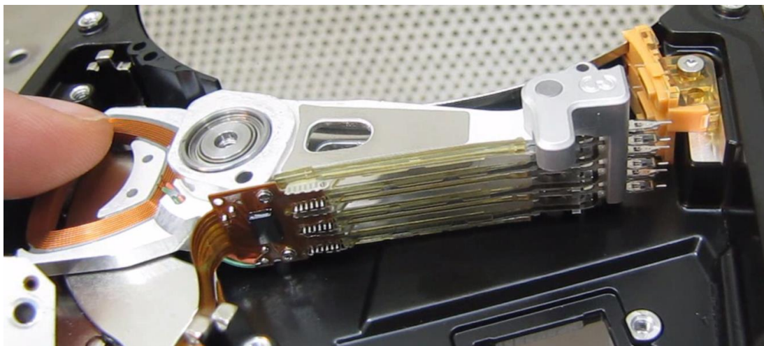
図 7.3 (ランプの外にヘッドを移動)
