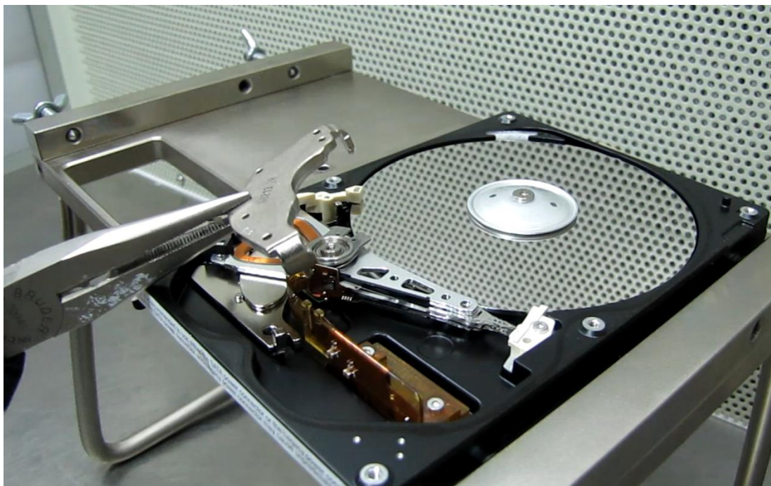
図 6.2 (ペンチを使用して上部マグネットを取り外す)
