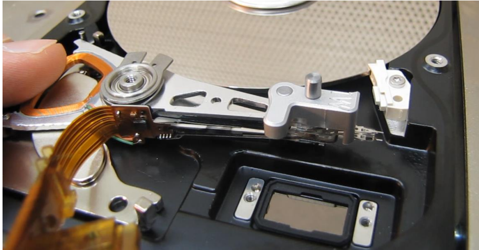
図 6.7 (ランプの外にヘッドを移動させる)
