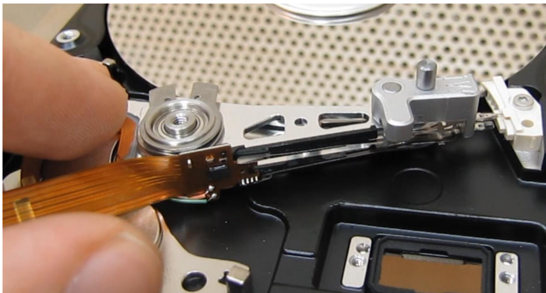
図 6.12 (障害ドライブのランプにヘッドを移動させる)
