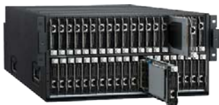
ベースユニット (クライアントモジュール40枚搭載)
