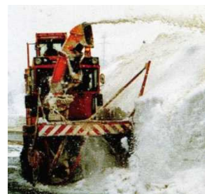
▲高所運転室から投雪位置を確認できるロータリ除雪車
