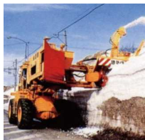
▲高い雪壁を切り取るロータリ除雪車
