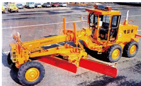
▲2枚のブレードで除雪幅を変えられる除雪グレーダ
