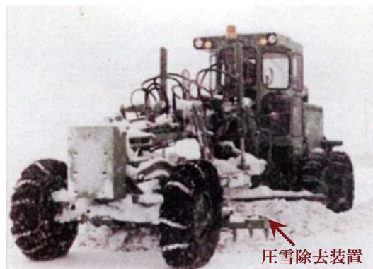
▲ノミ型破碎爪をもつ除雪グレーダ
