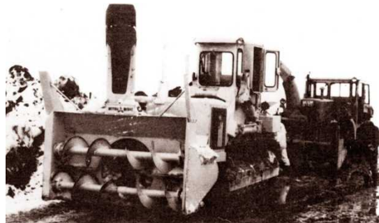
▲ブルドーザにロータリ除雪装置を架装して使用
