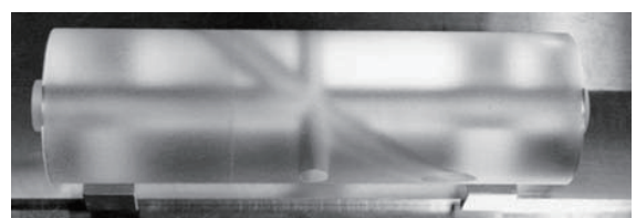
図 3 実験に用いたスーパー空洞 (全長 20cm)
