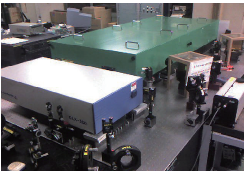
図2 ピコ秒レーザー損傷評価用光学配置
