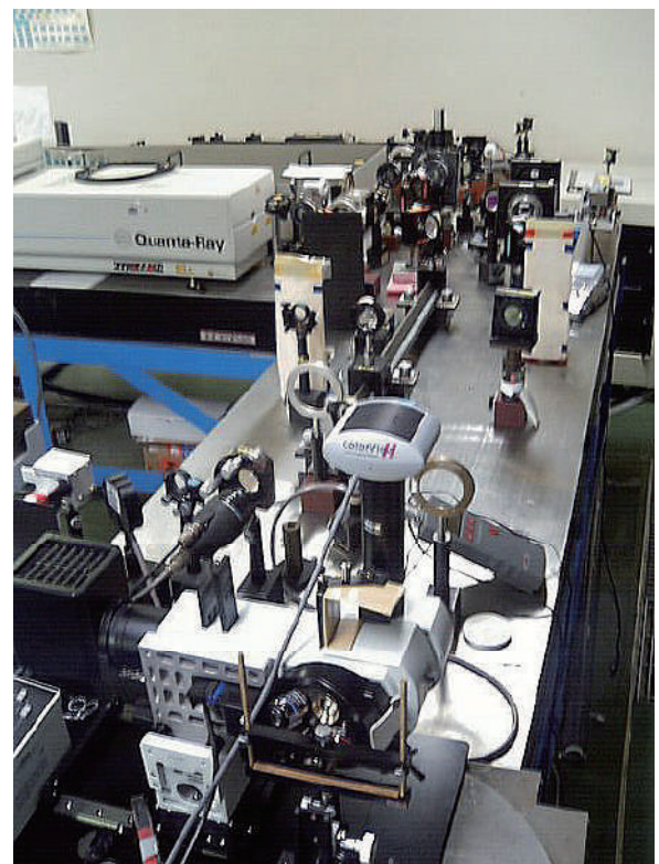
図1 ナノ秒レーザー損傷評価用光学配置
