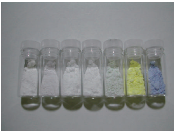
図2 種々の添加元素を加えた YAG 粉体材料
