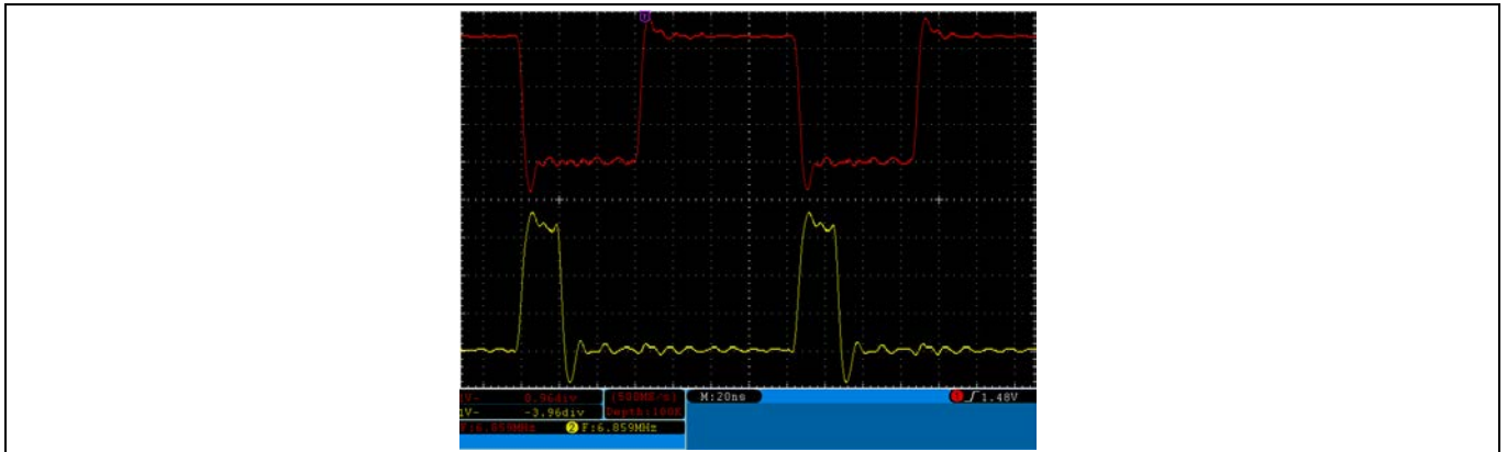
Figure 28 最上部: 「Divide by 7」 ; 最下部: 「stb」 ; 信号は 1 クロック幅 (参照のため)
