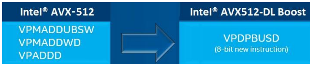
図 18. 新しい VPDPBUSD 命令で古い 3 つの命令を置き換える
