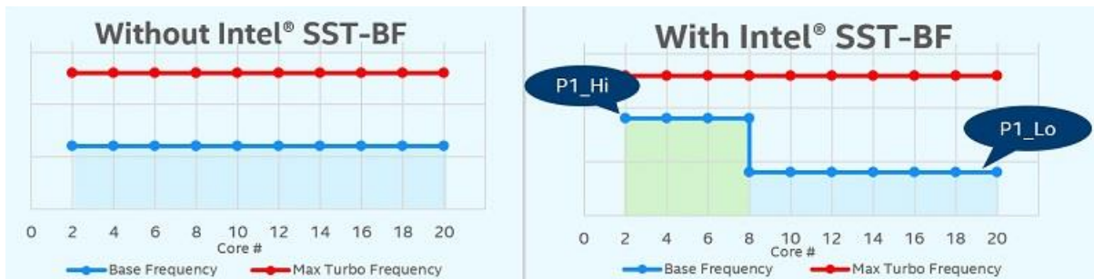
図 20. インテル® Speed Select Technology - Base Frequency (インテル® SST-BF) あり/なしのプロセッサの比較 (コア数は説明を目的としたものです)
