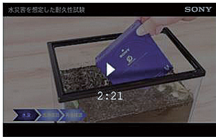
図3 オプティカルディスク・アーカイブカートリッジ(AD使用)耐久実験(水没実験)
