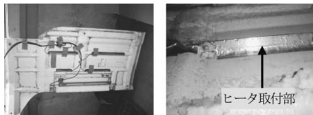
図3 台車カバー融雪ヒータ
