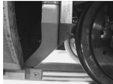
図12 台車端部フサギ板の形状変更
