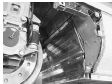
図9 空気圧膨張ブーツ
