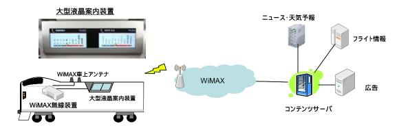
大型液晶案内装置の車上-地上間通信構成
