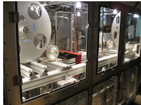
図 1. リール式高速磁気顕微鏡
