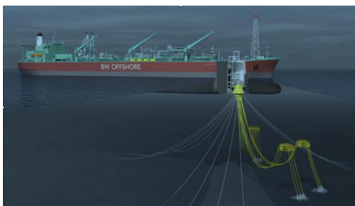
図 3-6 タレット係留の仕組み
