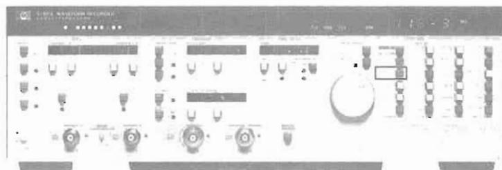
5180Aに接続されたCRTディスプレイには、単一波形（トレース1）または2波形（トレース1およびトレース2）が表示できます。
