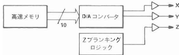
図-A デジタルデータはXYZドライブ用にD/A変換される。
