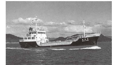
秀華丸。初代秀華丸のリブレース船で船名もそのまま引き継いでいる。4隻目の溶融カプロラクタム専用特殊タンク船となる。193.00GT、293.73DWT
