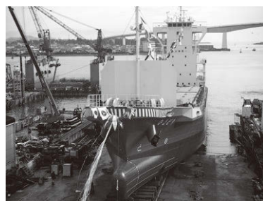
ひよどり。コンテナ船。竣工当時、内航業界最大のコンテナ積載量251TEUを誇った。 749.00GT、1,830DWT
