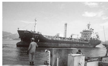
「KOYO MARU」。外航溶融硫黄専用特殊タンク船。3,535.00GT、4,300.00DWT
