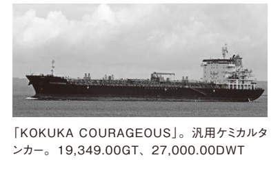
「KOKUKA COURAGEOUS」。汎用ケミカルタンカー。19,349.00GT、27,000.00DWT
