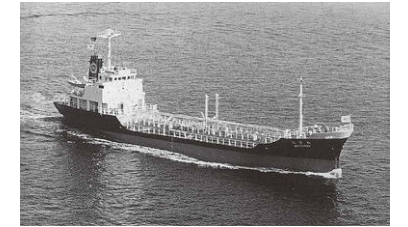
和昌丸。本船を皮切りに汎用ケミカルタンカーは大型から中型へと移行していった。499.00GT、1,272.25DWT
