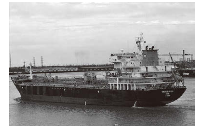
「KOKUKA GLORIOUS」。ブルネイメタノール輸送で活躍する汎用ケミカルタンカー。19,349.00GT、26,960.00DWT
