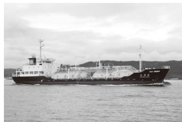
国周丸。液化アンモニア専用特殊タンク船。999.00GT、1,321.00DWT
