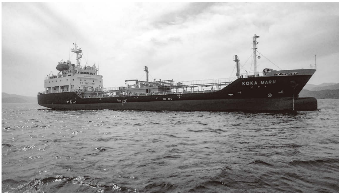
「KOKA MARU」。2017年9月に竣工した外航溶融硫黄専用特殊タンク船。最新の新造投入船。2,362.00GT、3,091.40DWT
