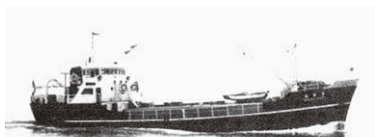
初代・秀華丸。2隻目の溶融カプロラクタム専用特殊タンク船。251.20GT、313.75DWT
