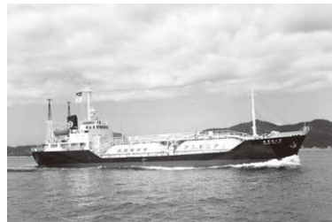
第二国周丸。液化アンモニア専用特殊タンク船。外航ではフィリピン、マレーシア、韓国向けなどの輸出に活躍した。1,588.77GT、1,374.50DWT
