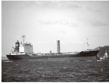
「SULPHUR ESPOIR」。外航溶融硫黄専用特殊タンク船。2,976.00GT、3,999.00DWT
