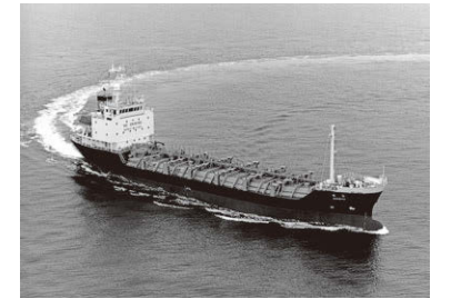
「CHISHU」。2003年に運航を開始した外航溶融カプロラクタム専用特殊タンク船。1,865.00GT、1,850.00DWT
