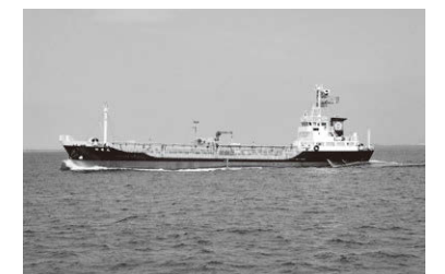
「双菱丸」。過酸化水素水専用船。498.00GT、1,296.40DWT
