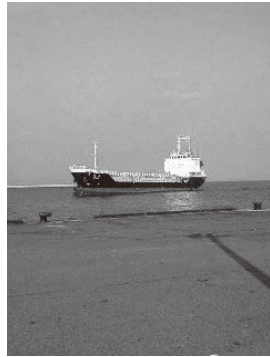
「明秀」。内航溶融カプロラクタム専用特殊タンク船。1,502.00GT、1,905.87DWT
