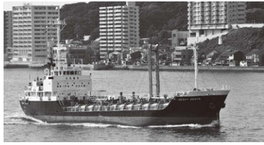
サルファーメルコール。内外航併用、溶融硫黄専用特殊タンク船。696.00GT、1,224.70 DWT
