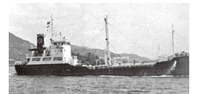
第二光華丸。内外航併用、溶融硫黄専用特殊タンク船。韓国向け輸出に不定期で運航していた。496.70GT、876.88DWT
