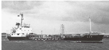
明華丸。キシレン、MMA等の輸送に従事した汎用ケミカルタンカー。649.81GT、1,289.68DWT
