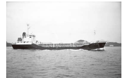
菱水丸。過酸化水素水専用船。2010年1月まで運航していた。494.00GT、1,231.00DWT
