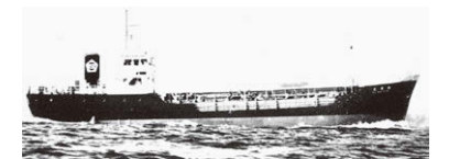
由華丸。当社初のステンレスタンク船。高品質のエチレングリコール輸送を高度品質管理船として実現した。三菱油化(株)、日曹油化(株)のエチレングリコール輸送取引を担当。321.69GT、453.26DWT
