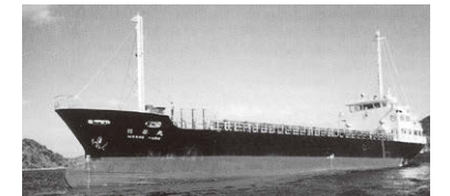
日昇丸。重心の高いコンテナ輸送。練りこまれた船殻設計により199GTサイズの小船でありながら野島崎越え、日立港への航海に耐えた。199.00GT、650.00DWT
