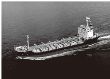
「EISHU」。アジアで活躍した大型外航溶融カプロラクタム専用特殊タンク船。1,865.00GT、1,866.00DWT
