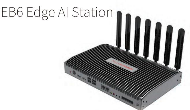
EB6エッジAIボックスは、エッジコンピューティングデバイスとして強大なAI処理性能を保有します。 SoC上の15TOPSにプラスした専用推論アクセラレータによって、さらに70TOPS、合計85TOPSの推論性能 を発揮する他、インダストリアルデザインによって信頼性と堅牢性を確保しています。強大なAI処理性能と Osware.Edge が組み込まれ、エッジ-クラウドソリューション、AIアルゴリズムやアプリケーションのリ モートデプロイ、FOTAなどが様々なフィールドでのアプリケーションを実現します。 スマートヘルスケア、スマートビルディング、スマート電力網、スマート交通監視、スマートファクトリー など多くの複雑なユースケースをカバーします。
