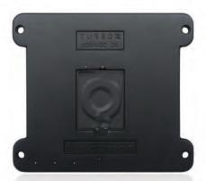
TurboX SDW4100評価キットは、Qualcomm Snapdragon 4100 ウェアラブルプラットフォームと TurboX Wear OSで構成され、主要なウェアラブルデバイス向けの機能をAndroid上で提供します。 豊富なインターフェースと周辺をサポートし、モジュラー設計となっているため、開発者はFPCを 再デザインすることで、コンポーネントのカスタマイズが可能です。本評価キットは、標準ソフトのベースラインも含んでいるため、開発者は性能評価に専念したり、ウェアラブル商品のプロトタイプを迅速に実現するなど、開発を加速させることができます。
