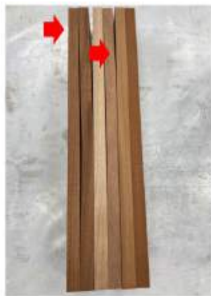
左から2本ずつトゥーナ、ニーム、マホガニー （赤矢印部分に反り、ねじれが見られる）
