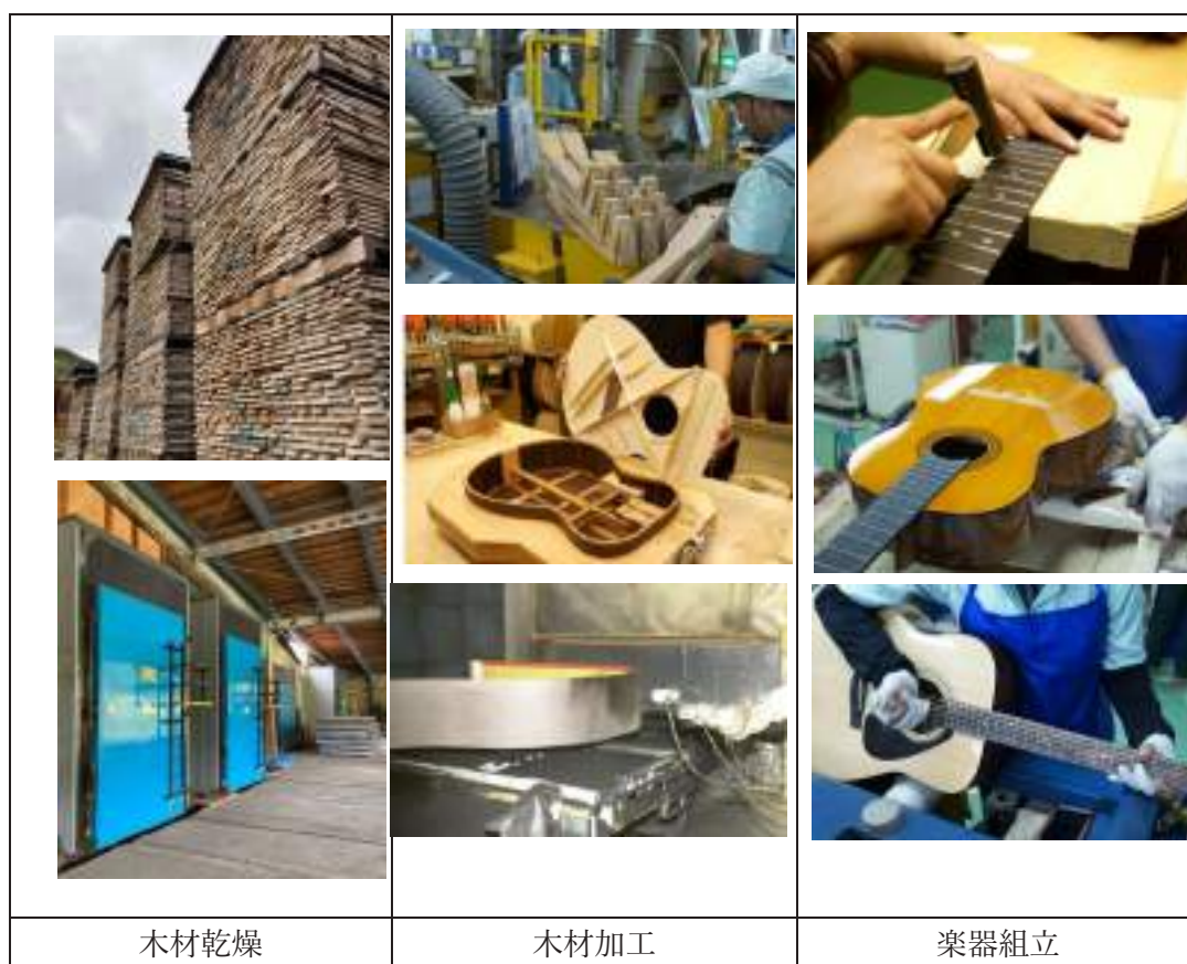
図 IV-8 木工加工・楽器生産工程
