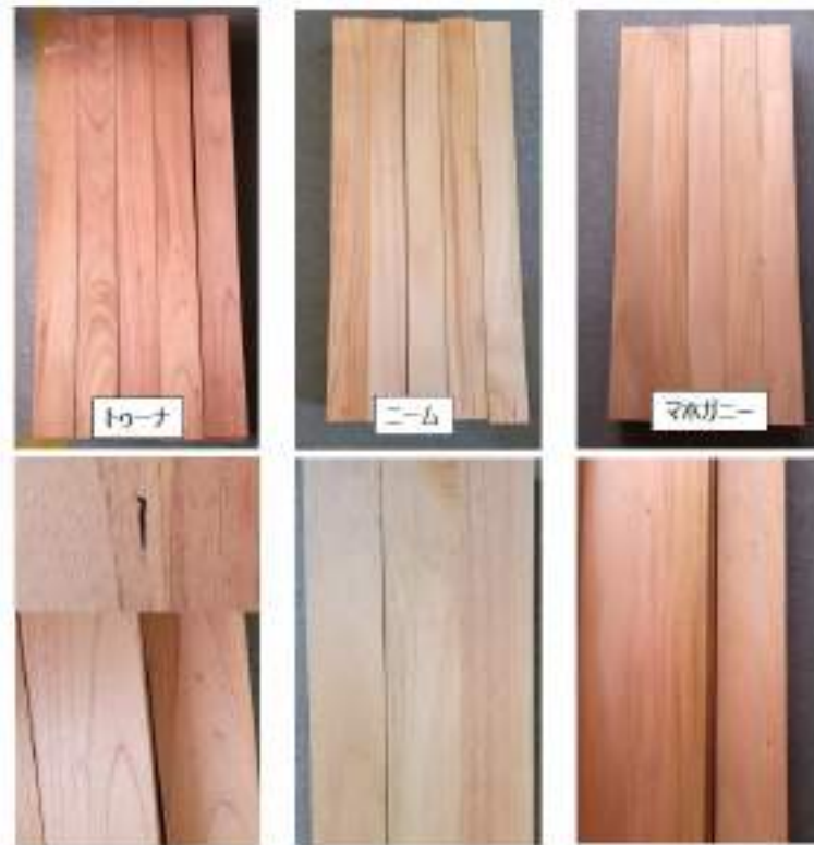
図 IV-16 トゥーナ、ニームと現行材の外観比較（下段は代表的な欠点例）
