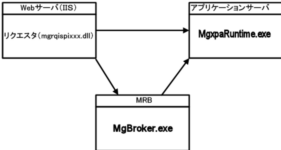
リクエストが Web サーバで用意されると、動作している Magic エンジンを見つけるために、リクエストは MRB にポーリングを出します。MRB は、処理中でないエンジンを見つけ、どのエンジンが処理可能かをリクエストに知らせます。
