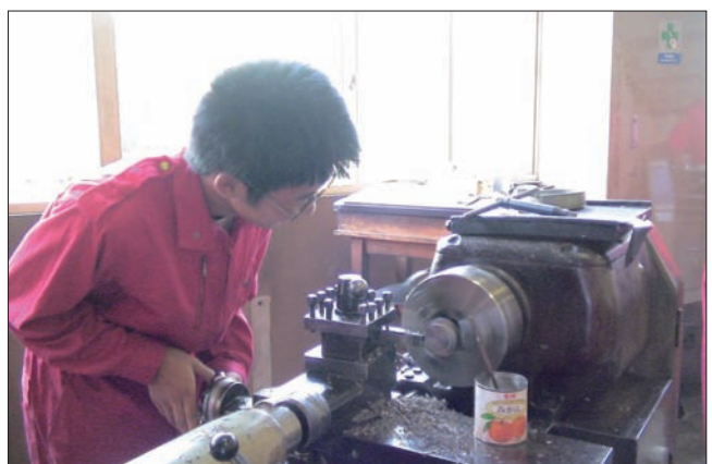
■写真1 アルミ材からモーターの軸を支えるパーツを旋盤という工作機械で作る筆者
