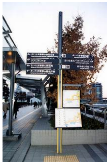
F 音声案内誘導装置 付案内ポール 上部は電光掲示盤。
