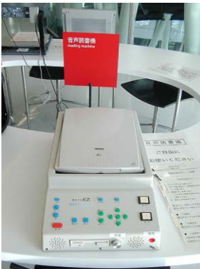
I 音声読書器 墨字資料をスキャナーで読み取り、自動音読される。
