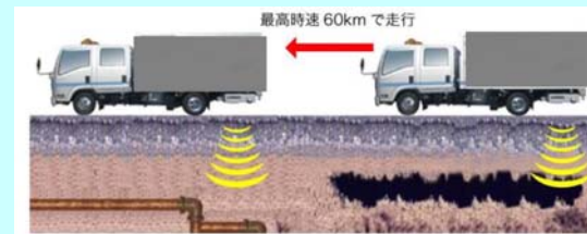
マイクロ波を照射して異常箇所を発見します
