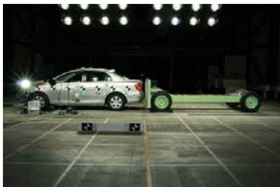
調査研究で行った実車後面衝突試験
