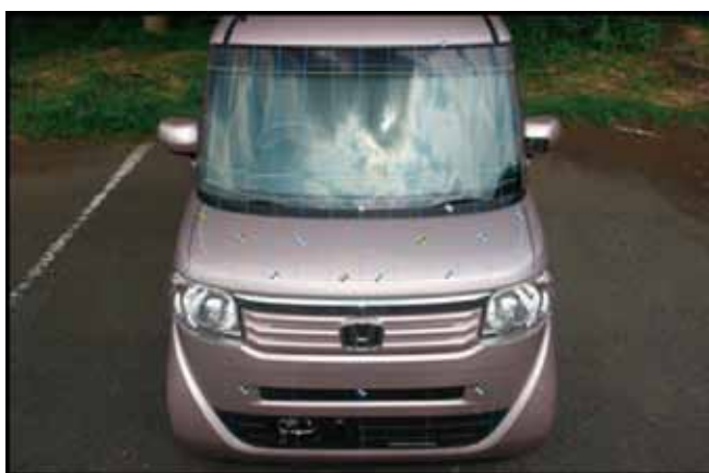
【頭部・脚部保護性能試験の打撃位置】
