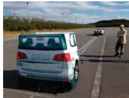
【目標試験車両の牽引状態】
