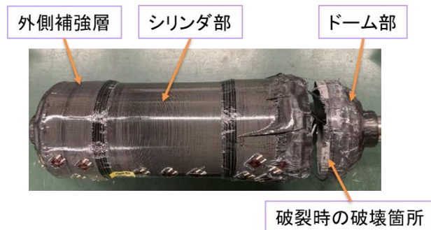
図 2 設計・試作・破裂試験を行った分割成形型圧力容器 #4 (破裂圧力 50.3 MPa) (アルミライナー、プリプレグ+オートクレーブ成形)
