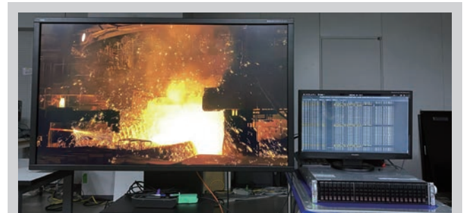
図3-16 開発したVVCリアルタイムデコーダーと復号映像
