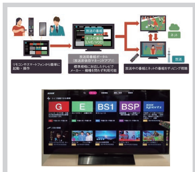
図5-2 放送とネット動画をシームレスに遷移する放送非依存マネージドアプリケーション
