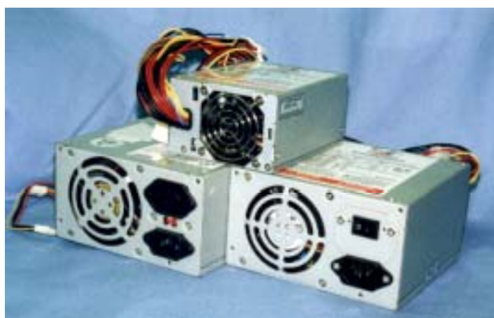
写真 2.1 左下が AT 電源、右下が ATX 電源、中央上が SFX 電源。SFX 電源の外形寸法は 3 種類提案されている。同じ SFX 仕様でもケースに装着できるかどうか確認が必要。AT 電源にはアウトレットが付属している。
