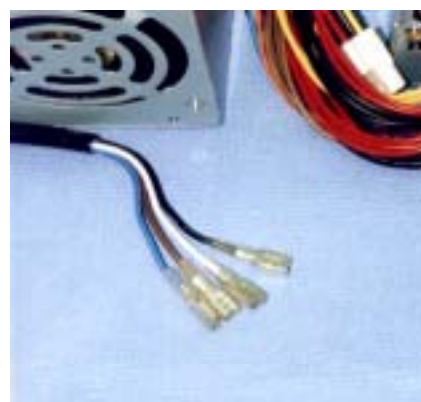
写真 2.4 AT 電源のファストン端子。ここにスイッチを接続し、スイッチを手動で入切りすることで電源を ON/OFF する。
