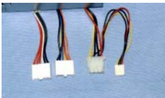
写真 2.2 AT 電源のコネクタ。左からメインコネクタ(6Pin x 2ヶ)、ペリフェラルコネクタ、FDD コネクタ
