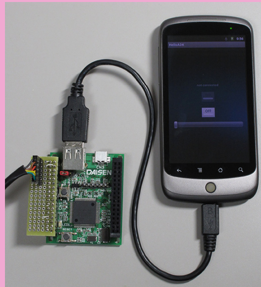
LM3S3748でADK CQ出版「超入門!付属ARMマイコンで 始めるロボット製作」基板
