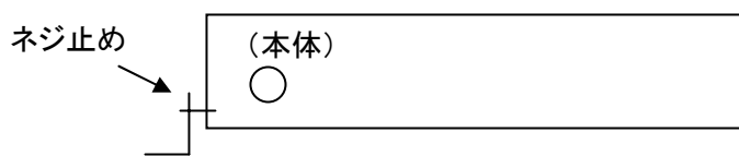
図 31-4 本体に金具をネジ止め
