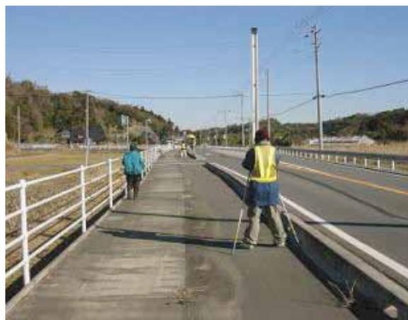
写真1-1-1 水準測量の実施状況
