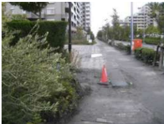
A タイプと C タイプ～D タイプの被害部分との境目。おひさま公園南西端付近。赤いコーンより先の南西側では急に地表面の変形や噴砂はなくなり、液状化-流動化現象は起こっていないと考えられる。3/23 撮影。
