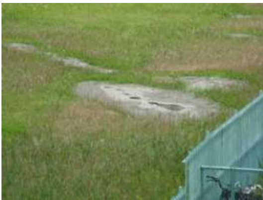
B タイプの被害部分. 舞浜駅前での噴砂. 線状 (北西方向) に並ぶ. 5/17 撮影.
