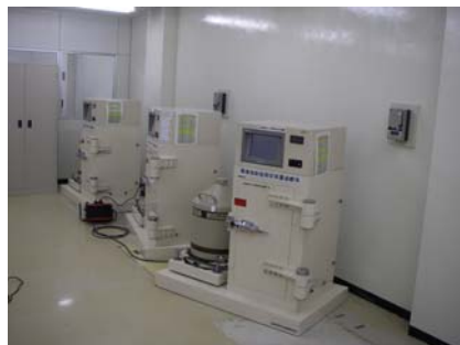
Ge半導体検出装置 (環境管理棟)
