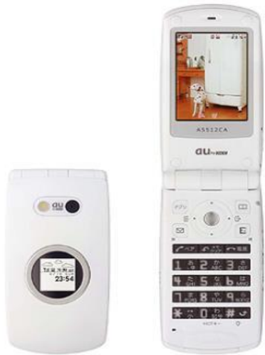
Casio A5512CA (MSM6550) 2.2" QVGA Display (320x240) 1.3 MP camera
