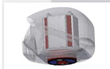
固定翼機 DIAMOND DA42 MPP のノーズパッドへの取付け
