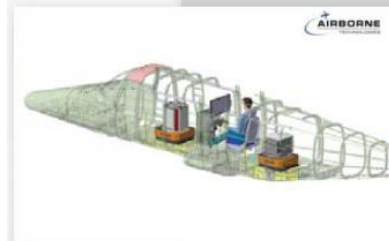
固定翼機 A-VIATOR AP68PT-600 の固定されたプラットフォーム GSM-3000 への取付け
