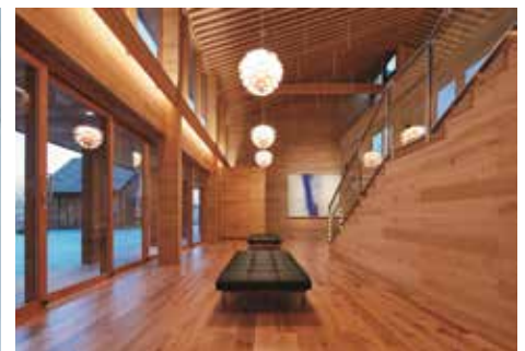
●ケース3の例 スプリンクラーを設置して内壁や構造材を木質化したリハビリテーションのクリニック（千里リハビリテーション病院アネックス棟）
