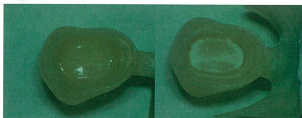
fig.12 切削しエアード乾燥後のCAD/CAM冠の内面。 (左)注水式、(右)乾式 乾式では隅角部に切削屑が残っている。
