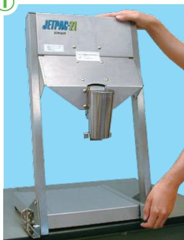
本体を作業台の前面にセットします。
