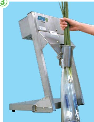
スイッチを入れると、吹き出し口からの風により、袋が自動的に開くので商品をホッパーの中に投入します。
