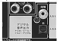
光と同軸各1系統のデジタル音声出力端子を装備
