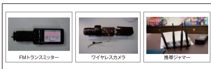
図表5-3-3-3 無線通信に障害を与えた不適合機器の例
