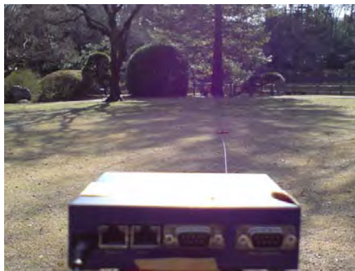
図 4-41 Bluetooth アンテナ特性測定環境
