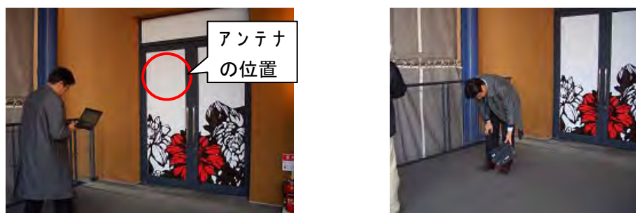
図 4-3 無線LAN受信信号強度測定の様子
