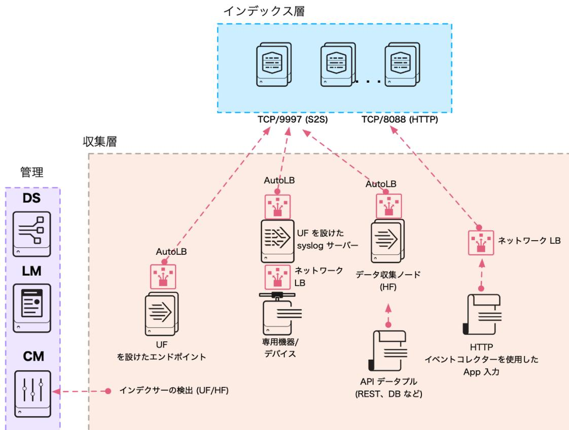
上の図では、データ収集コンポーネントの設定を管理するデプロイサーバー（DS）が管理層に示されています。また、データ収集ノードは Splunk Enterprise の機能を有効にするためにライセンスマスター（LM）にアクセスする必要があるため、LM も示されています。クラスタマスター（CM）がある場合は、フォワーダーがインデクサーを検出するために使用できるため、フォワーダー出力設定で利用可能なインデクサーを管理する必要がなくなります。
