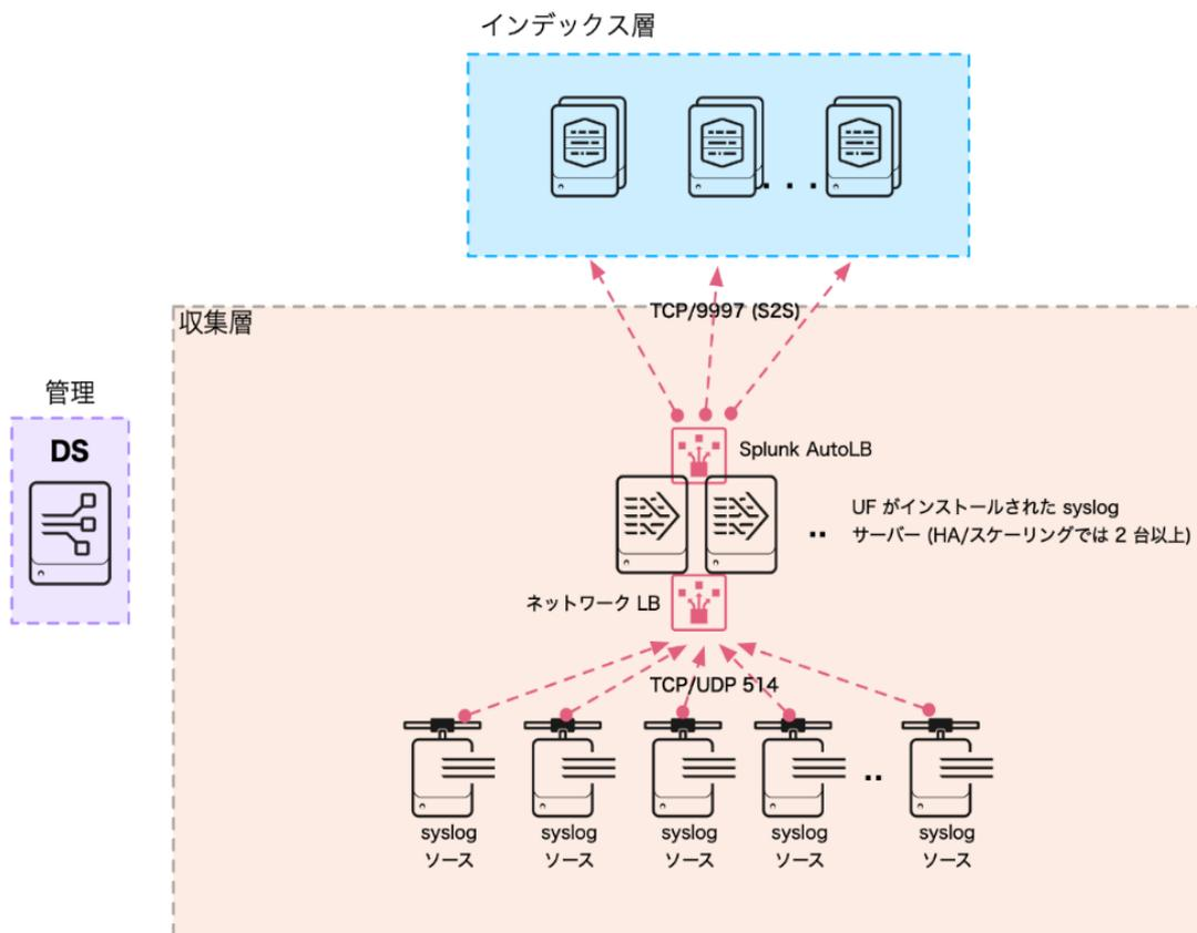
この図は、ポート 514 で TCP または UDP を使用して syslog サーバーのロードバランシンググループにデータを送信する syslog ソースを示しています。複数のサーバーにより、収集層の高可用性が保証され、メンテナンス中のデータロスを防ぐことができます。各 syslog サーバーは、syslog イベントが各ソースタイプ（ファイアウォールイベント、OS syslog、ネットワークスイッチ、IPS など）ごとの専用のファイル/ディレクトリに書き込まれるようにするためのルールを syslog ストリームに適用するように設定されます。各サーバーにデプロイされる UF はこれらのファイルを監視して、データが適切なインデックスに処理されるようにインデックス層に転送します。Splunk AutoLB を使用することで、利用可能なインデクサー間でデータが均等に配分されます。
