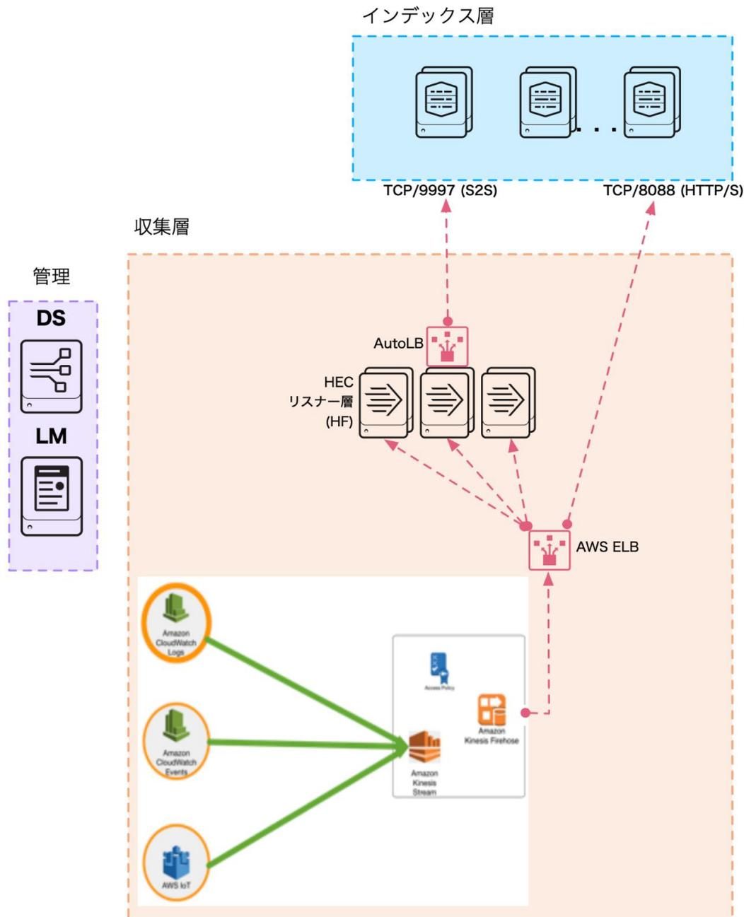
この図は、Kinesis を Firehose に送信する AWS ログソースを示しています。Firehose は、適切な設定により、AWS ELB 経由で HEC リスニングサービスにデータを送信します。ここでも、HEC リスニングサービスをインデクサー上で直接ホスティングするか、または専用の HEC リスナー層を設けることができます。詳細については HEC のセクションを参照してください。
