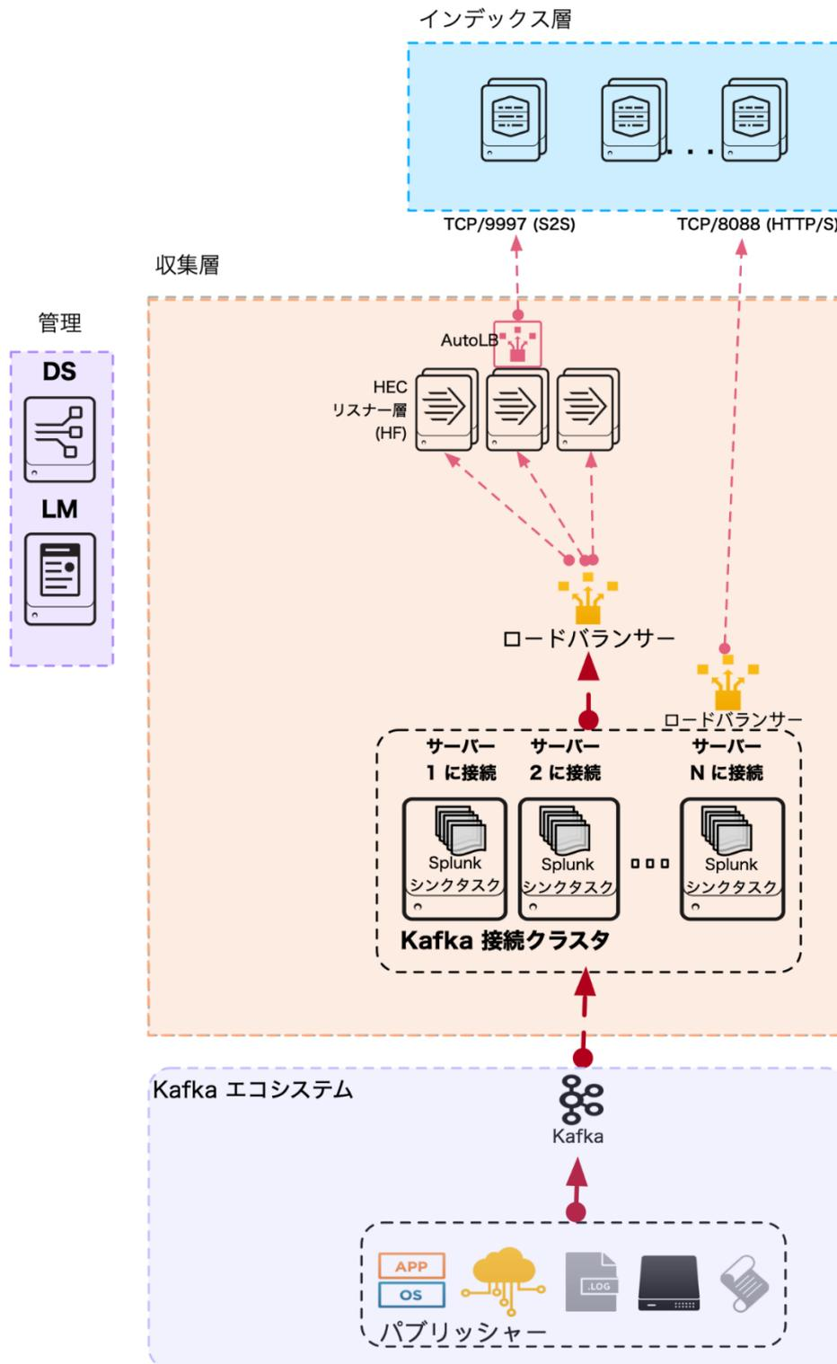
この図は、Kafka バスにメッセージを送信する Kafka パブリッシャーを示しています。Kafka Connect クラスタでホスティングされるタスクは、Splunk Connect for Kafka 経由でこれらのメッセージを消費し、ネットワークロードバランサーを使用して HEC リスニングサービスにデータを送信します。ここでも、HEC リスニングサービスをインデクサー上で直接ホスティングするか、または専用の HEC リスナー層を設けることができます。詳細については HEC のセクションを参照してください。管理層コンポーネントは、専用の HF 層をデプロイして HEC リスナーをホスティングする場合にのみ必要です。
