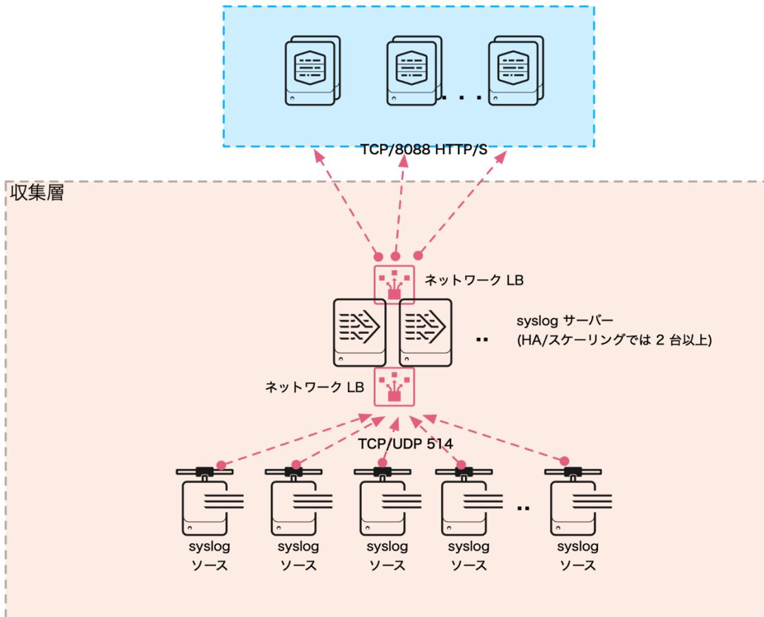
このトポロジーの利点は、UF/HF のデプロイと設定が不要なことです。HTTP ロードバランサーは、インデクサー（または専用 HEC リスナー層）上で HEC リスナーとして機能し、HEC エンドポイント間でデータを均等に配分します。このロードバランサーは、「最小接続」ポリシーで設定します。
