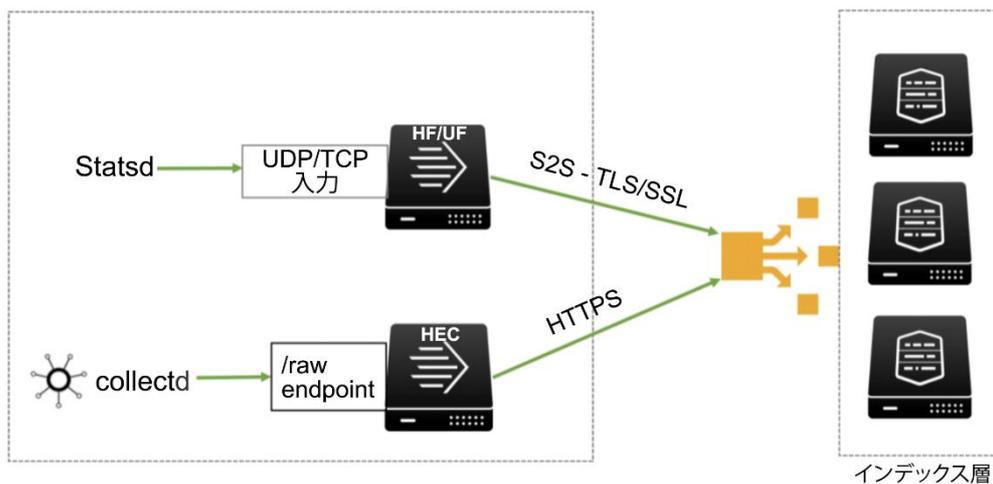
statsd は現在、UDP および TCP トランスポートをサポートし、Splunk フォワーダーまたはインデクサー上の直接入力として使用できます。ただし、このアーキテクチャは回復性が低く、Splunk フォワーダーの再起動によるイベントロスが発生しやすいので（syslog 収集参照）、実働環境では TCP/UDP トラフィックを直接フォワーダーに送信することがベストプラクティスです。
