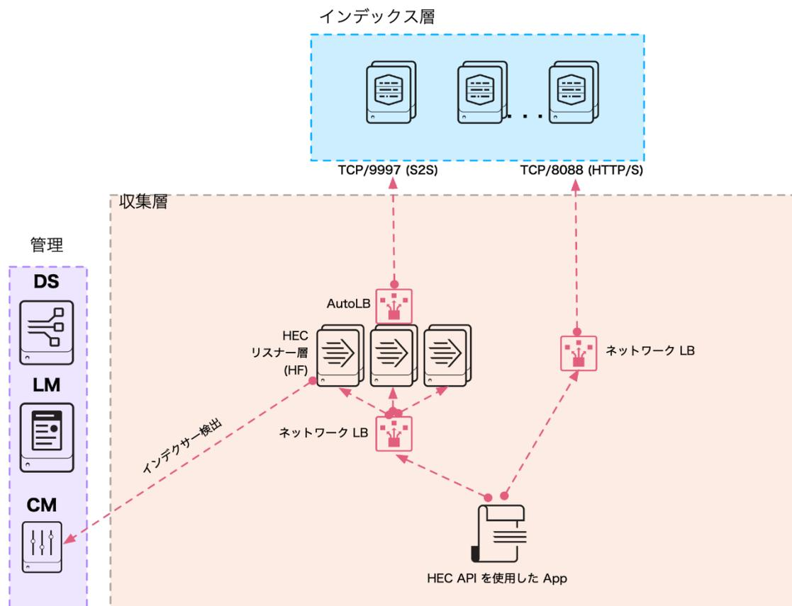
管理層には (HF が必要とする) ライセンスマスターと、リスナーコンポーネント上の HTTP 入力を管理するデプロイサーバーがあります。注意: インデックス層をクラスタ化して HEC トラフィックを直接受け取る場合、HEC 設定はデプロイサーバーではなくクラスターマスターによって管理されます。
